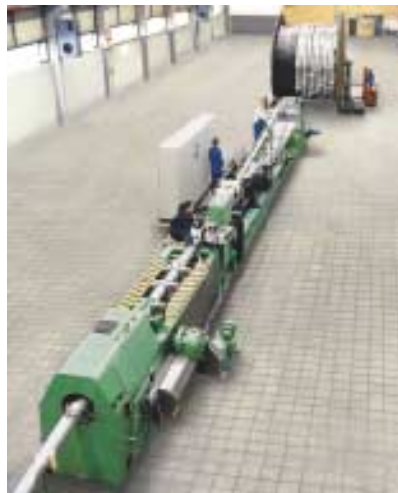
Fertigung von vakuumisolierten CRYOFLEX®-Leitungen Production of vacuum insulated CRYOFLEX® Transfer Lines
